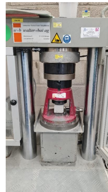
Compression test EN 12390-3
